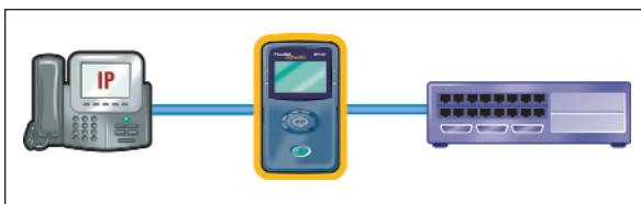
Рисунок 3: Подключение прибора NetTool VoIP между IP-телефоном и коммутатором позволяет проверить подачу питания и убедиться в том, что сетевые компоненты работают должным образом.
