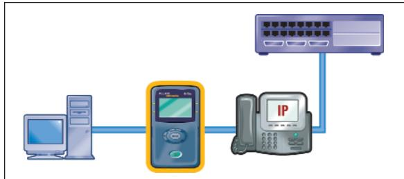
Рисунок 5: Прибор NetTool VoIP можно подключать "в разрыв" между персональным компьютером и IP-телефоном, чтобы диагностировать компьютерные проблемы.
