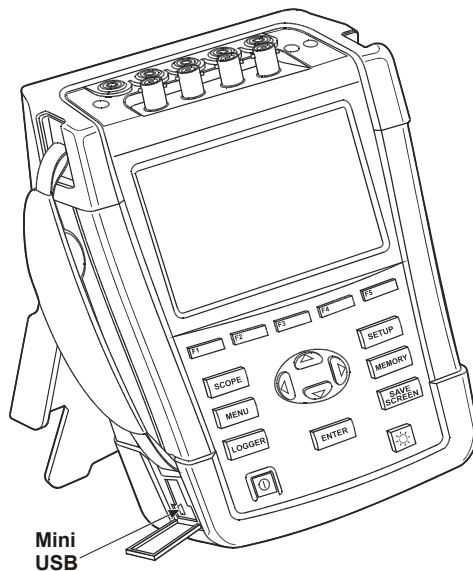
Рис. 25-1. Расположение соединительного USBразъема
