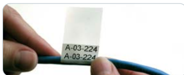
1. Закрепите маркер с нанесенным текстом на проводе
