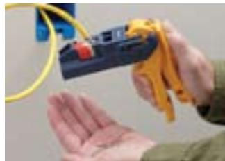
6. Провода будут установлены и обрезаны для обеспечения надежной заделки.
