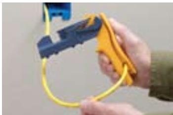
1. Удалите изоляцию кабеля с помощью стандартного или встроенного инструмента для зачистки кабеля.
