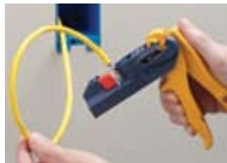
3. Вставьте разъем в JackRapid передним концом вперед, направляя IDC-контакты в сторону лезвий инструмента.
