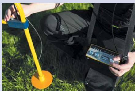
Локатор для точного поиска места повреждения оболочки кабеля
