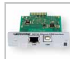
Сдвоенный интерфейс Ethernet/USB H0730 (опция)
