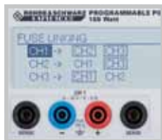
Индивидуально связываемые электронные предохранители посредством FuseLink
