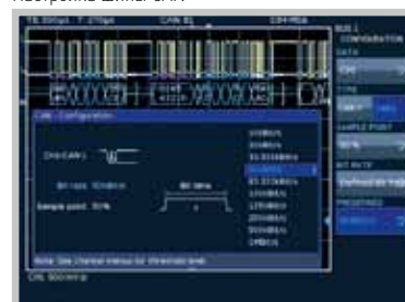
Настройка шины CAN
