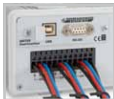
Выходы на задней панели для простого встраивания в стойные системы
