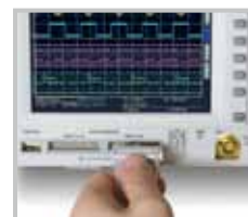
Многоконтактный соединитель для подключения логического пробника
