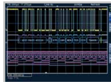
Отображение смешанного сигнала и шины
