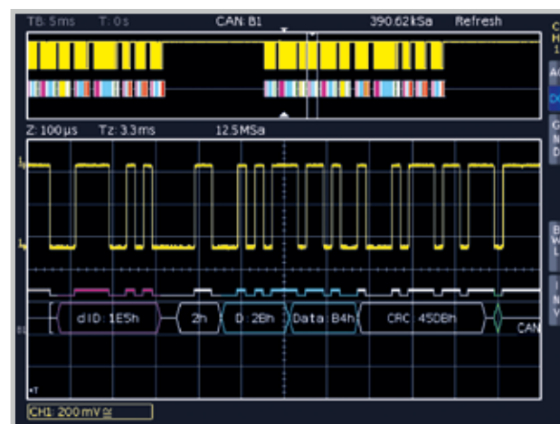
Шина CAN, отображение данных в формате HEX
