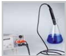
Измерение температуры датчиком HZ887 в составе прибора HM8112-3
