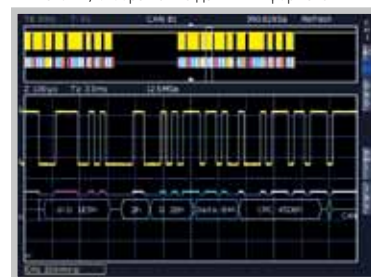
Шина CAN, отображение данных в формате HEX
