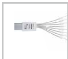
8-канальный логический пробник HO3508
