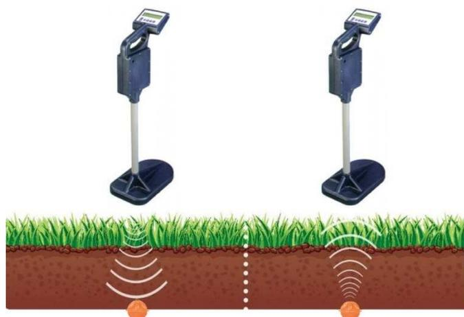
В зависимости от конструкции колебательного контура, маркер может иметь дипольную или сферическую диаграмму направленности.
