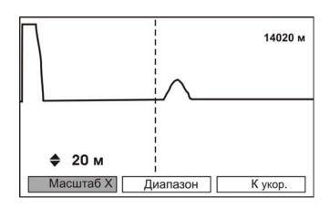
Корректное измерение расстояния проводится после ввода коэффициента укорочения. Нажмите кнопку «**К** укор.» и с помощью кнопок « $\uparrow$ », « $\downarrow$ » установите желаемое значение:
