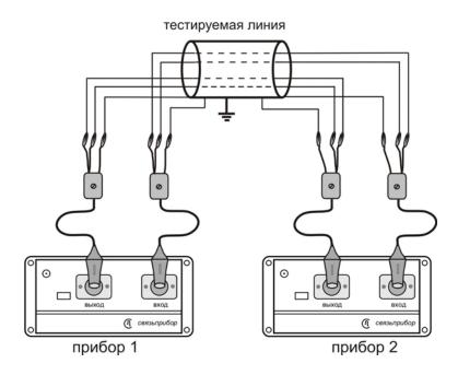
В последнем случае нагрузочные резисторы не нужны (Прибор 1 работает в режиме генератора - смотри пункт «Генератор»).
