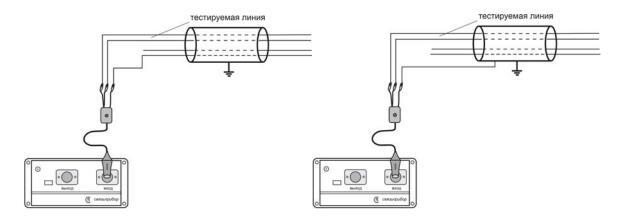
Если необходим режим сравнения жил из разных пар (функция двухканального рефлектометра), то ассиметричный вход следует подключить к двум жилам из разных пар, как показано на рисунке (предполагается, что одна из пар заведомо исправна):
