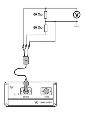
Используйте вольтметр для измерения уровня сигнала на любом из плеч нагрузки. (Обязательно применение делителя напряжения ДН, входящего в комплект вольтметра). Уровень плеч должен быть одинаковым и равным половине выходного уровня: 0,97 ± 0,06 В.
