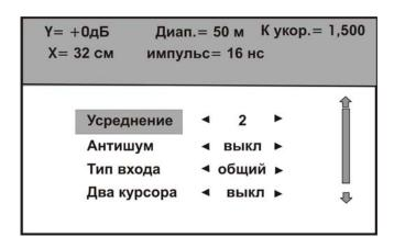
В верхней части экрана выводится информация о текущих настройках рефлектометра, которые задаются с помощью «горячих» клавиш. В нижней части экрана выводятся дополнительные настройки:
