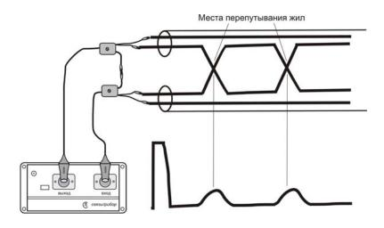
В режиме с ассиметричным входом зондирующий импульс подается одновременно в две жилы одной пары, а на экране отображается разница между отраженными сигналами. Такой режим позволяет точно определить расстояние до места нарушения симметрии пары (повреждения одной из жил пары). Для работы используйте одну из представленных схем:
