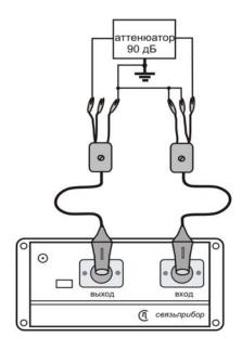
Для исключения наводок на вход прибора обязательно замкните неподключенное плечо входа рефлектометра на «землю».
