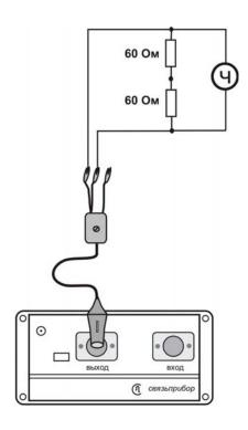
Включите режим «РЕФЛЕКТОМЕТР» в главном меню прибора. Нажав кнопку «ДОПОЛНИТЕЛЬНО», включите режим «КАЛИБРОВОЧНЫЕ МЕТКИ».
