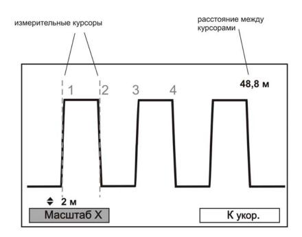
С помощью «горячих» кнопок «F3» и «F1» установите коэффициент укорочения 1,50 (по умолчанию) и масштаб по оси X (разрешение) 2 м. Навигационными кнопками «←» и «→» установите нулевой курсор на пересечении центра фронта первой метки (установлен по умолчанию), измерительный курсор совместите с центром спада первой метки (переключение курсоров — кнопка «ОК»). Снимите показания расстояния между курсорами (графа 1-2 в вышеприведенной таблице).
