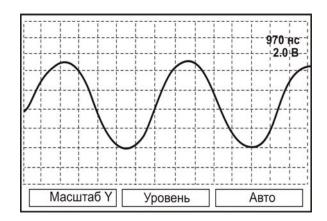
Кнопки «←» и «→» перемещают осциллограмму по горизонтали.
