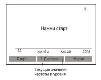
Измерение АЧХ проводится по заданному циклу частот. Измеритель может выбрать интервал 32-2208 кГц; 32-8192 кГц или 26-16384 кГц с помощью кнопки «Диапазон».
