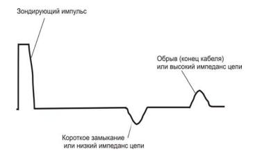
Наилучшие результаты достигаются при непосредственном подключении к паре. Линия передачи «жила-экран» обладает большим коэффициентом затухания и уровнем шумов.
