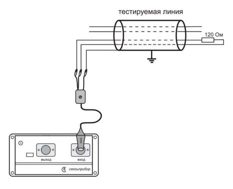
Для включения режима нажмите пункт «Шум» в режиме «Частотные измерения» или «горячую» кнопку «**Шум**» в главном меню прибора.
