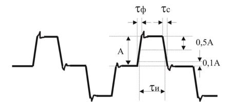
Проведите измерения амплитуды сигнала А, длительности импульсов ти, длительности фронта тф, длительности спада тс.
