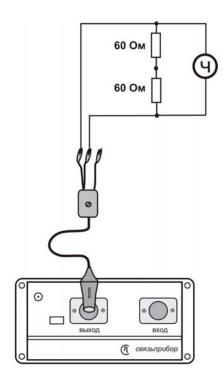
Измерения производятся для частот 16384.00 кГц и 32.00 кГц в режиме узкополосного измерения уровня. Полученные значения должны соответствовать заявленным в разделе технические характеристики настоящего руководства.
