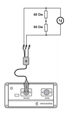
Включите режим «РЕФЛЕКТОМЕТР» в главном меню прибора. Нажав кнопку «ДОПОЛНИТЕЛЬНО», включите режим «КАЛИБРОВОЧНЫЕ МЕТКИ». Этот режим служит для проведения поверки (калибровки) рефлектометра.
