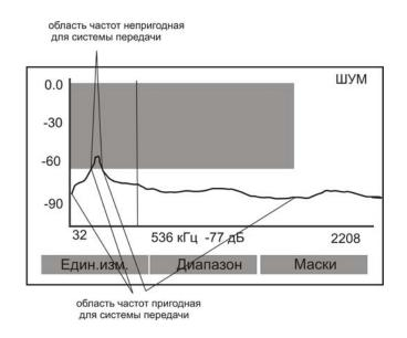
Для выбранного типа системы передачи пригодна та область частот, которая не попадает в выделенную часть экрана. Попадание частоты в выделенную область свидетельствует о том, что уровень шума превышает нормативный порог.
