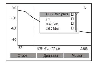
Для выбранного типа системы передачи пригодна та область частот, которая не попадает в выделенную часть экрана. Попадание частоты в выделенную область свидетельствует о том, что рабочее затухание превышает нормативный порог для данной системы передачи.
