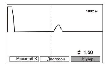
Если коэффициент укорочения неизвестен, но известна длина кабеля, установите курсор на конец кабеля. Затем, изменяя коэффициент укорочения выставите расстояние до курсора равное реальной длине. Данный метод хорошо работает для кабелей без вставок.
