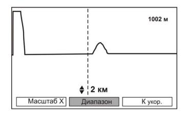
Прибор сам устанавливает оптимальную ширину импульса в зависимости от выбранного диапазона. Однако измеритель может изменять этот параметр для получения более четкой картинки. Для этого повторно нажмите кнопку «Диапазон» и с помощью кнопок « $\uparrow$ », « $\downarrow$ » выберете наиболее информативное значение. На малых расстояниях следует пользоваться короткими импульсами, а на больших — более длинными:
