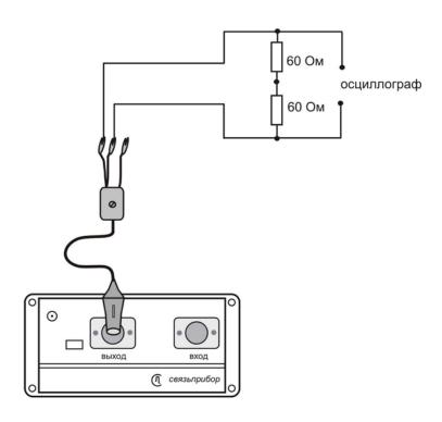
Используйте осциллограф для измерения сигнала на резисторе. На экране осциллографа должна наблюдаться осциллограмма, показанная на рисунке:
