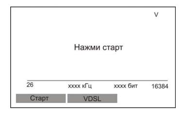
Выбор типа системы передачи осуществляется кнопкой «F2» (VDSL/ADSL/ADSL2/ADSL2+/SHDSL/SHDSL.bis), запуск кнопкой «Старт».
