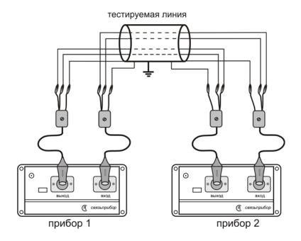
В последнем случае прибор 1 проводит измерения, а прибор 2 используется в качестве нагрузки.
