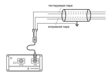
Отображаемая на экране разница отраженных сигналов позволяет точно определить расстояние до места, где пары отличаются друг от друга. Поскольку на экране показана разность сигналов, то по виду рефлектограммы нельзя судить о характере неисправности (обрыв или короткое замыкание). Для уточнения используйте режим общего входа.
