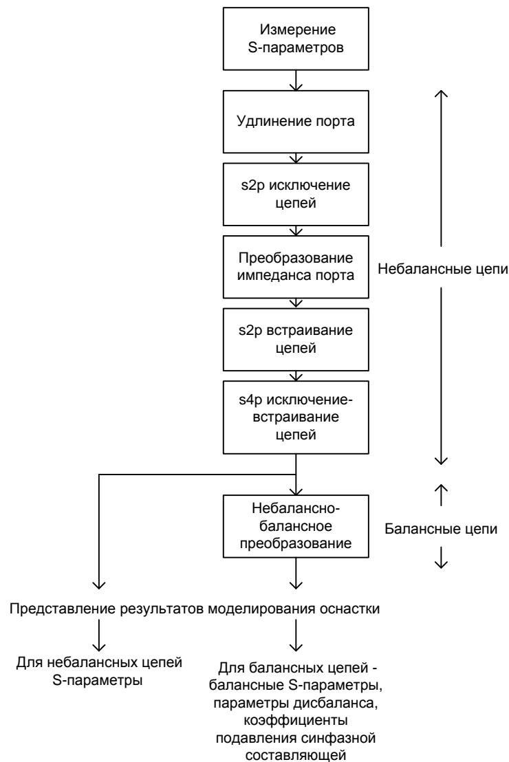
Рисунок 6.14 Схема обработки данных при моделировании оснастки
