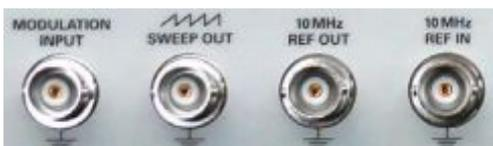
Рис. 8.1 – Входы и выходы сигнала на задней панели, включая вход модуляции
