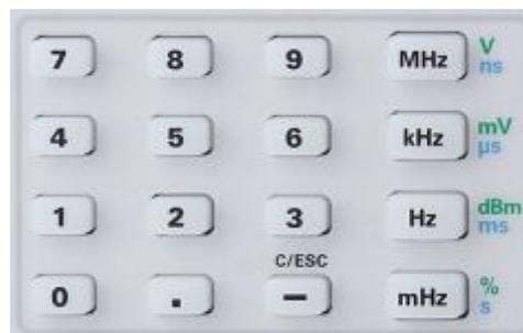
Рис. 4.2 – Цифровая клавиатура и клавиши выбора единиц измерения и сброса
