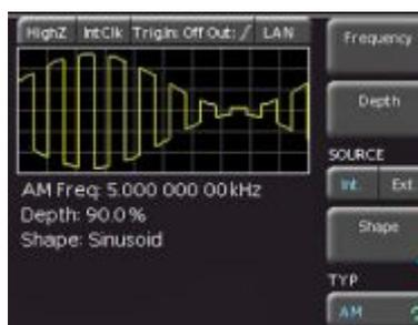
Рис. 3.2 – Дисплей прибора HMF 2550/2525
