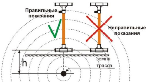
Не проводите определение глубины залегания коммуникации вблизи поворотов, отводов или тройников. Отступите, по крайней мере, 5 м от поворота или отвода для получения максимальной точности.
