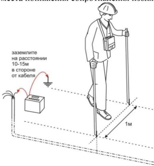
штырей следует заглублять в грунт точно над кабелем, а второй - слева или справа перпендикулярно трассе на расстоянии примерно 1 м.
