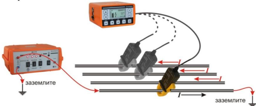
При работе на «холостом» ходу возможна значительная наводка на соседние жилы и отбор кабеля индуктивным определителем затруднен. В этом случае рекомендуется
