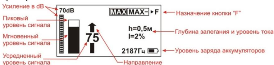
Встаньте с антенной (как показано на рисунке) над предполагаемой трассой в направлении движения от генератора к дальнему концу кабеля. Нажав кнопку
