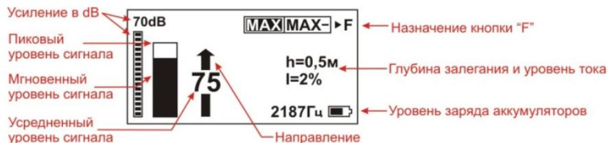
Расположите антенну в положение по максимуму, расположение кабеля определяется по максимальному уровню
