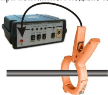
При подключении генератора при помощи клещей-индуктора достигается более высокий уровень сигнала в линии и значительно снижается влияние на соседние магистрали. Клещи представляют собой индукционную катушку с разъемным магнитопроводом, который замыкается вокруг тестируемого кабеля.
