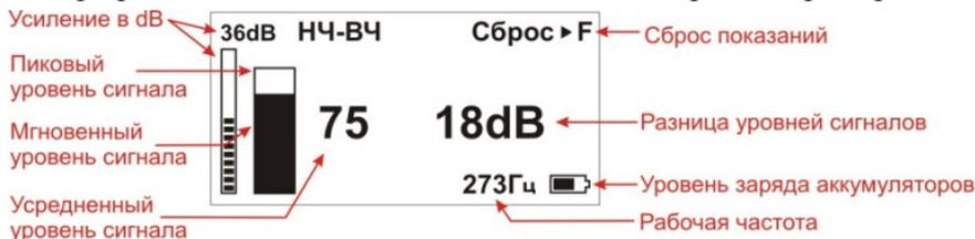
По максимальному уровню сигнала найдите точное положение кабеля. Значение dB на дисплее покажет, есть ли повреждение, 36dB – нет повреждения, меньше – есть. При движении вдоль исправного участка кабеля (трубы) значение будет неизменно, при прохождении места повреждения значение в dB уменьшится. Уменьшение более 4-5dB стоит расценивать как наличие повреждения. Чем более низкое значение достигнуто, тем более низкоомное повреждение присутствует.
