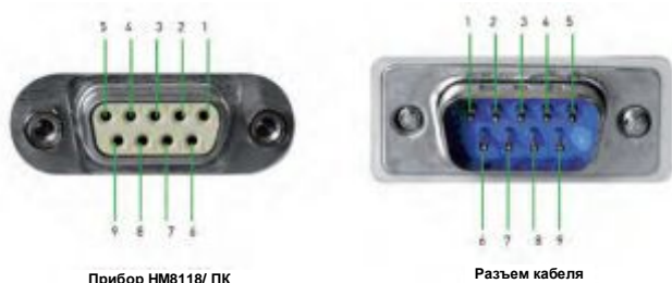
Рис. 8.1 – Назначение контактов интерфейса RS-232
