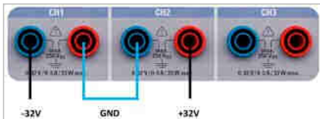
Рис. 6.11 – Подключение для источника R&S®HMC8043
