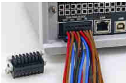
Рис. 6.2 – Подключаемый к блоку выводов разъем HZC40 (поставляется без кабеля)
