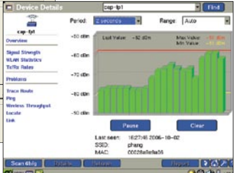
Рисунок 4 График мощности сигнала, оптимизированный для охоты за неавторизованными беспроводными устройствами
