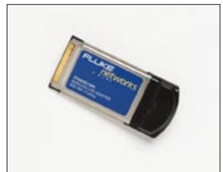
Рисунок 2 Стандартная беспроводная сетевая карта с антенной с круговой диаграммой направленности
